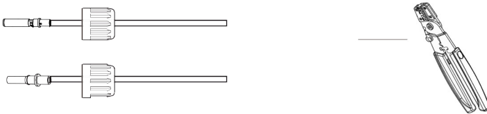
Figura 5.4 Crimpe o pino de contato ao condutor
